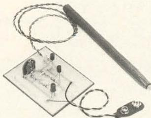
Voici le détecteur de température qui permet d'économiser le chauffage sans grelotter. Il arrête ou met en route mon chauffage en fonction de la chaleur ambiante.
