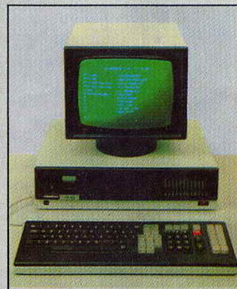
Curiosité. Le Robotron , micro-ordinateur personnel fabriqué en République démocratique d'Allemagne. Malgré sa compatibilité CP/M 2.2, il a bien peu de chances de s'imposer en Europe de l'ouest !
